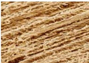
**Поверхность древесины, обработанная шлифовальным материалом с карбидом кремния.**
