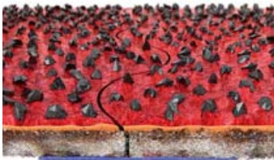
Шов TS – это волнообразное соединение встык, при котором края ленты обрабатываются S-образным ножом для получения волнообразной формы края. Шов TS позволяет избежать разъединения, возможного для шва T, т.е. лента со швом TS легче поддается изгибу в месте шва. Шов TS наиболее типичен для лент на тканевой основе, хотя встречается его применение и при изготовлении бумажных лент. Наилучшим этот тип соединения является для лент с тонкой и средней градацией зерна.
